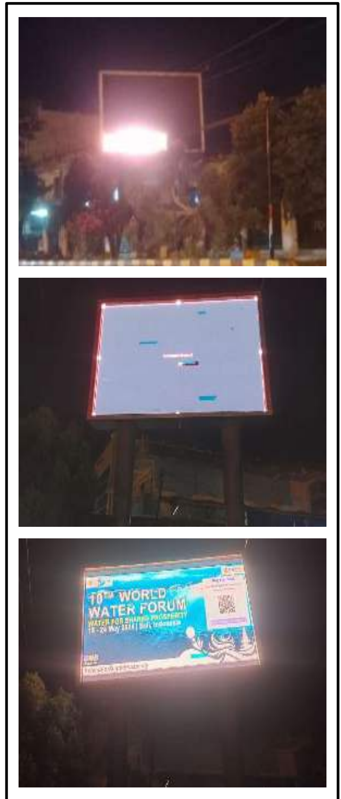
Videthrone Kotaraja Padam Sebagian Besar Dikarenakan Power Suplay Yang Sudah Rusak dan PC Komputer Sudah Mulai Tidak Merespon Atau Sudah Sulit Diremot Dari Kantor Sehingga Konten Video Atau Gambar Tidak Bisa Tayang
